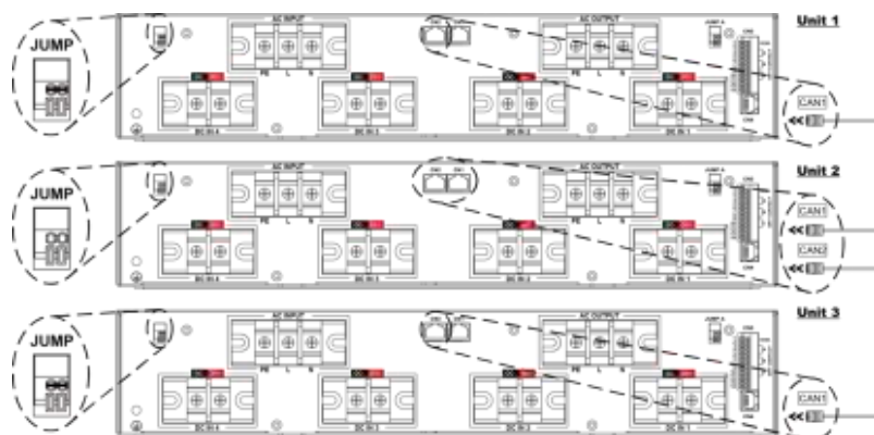
Schéma 7-3 – Configuration des cavaliers A & B pour la connexion en parallèle des racks
