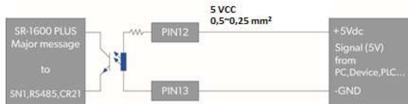
Schéma 6-3. Contacts secs - Broches 12~13 (alarme majeure)
